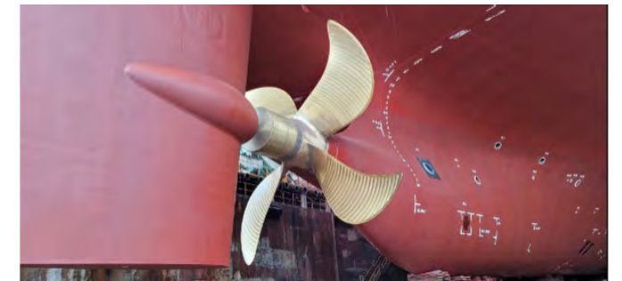
신조선에 설치된 추진력 향상 장치 (Rudder Bulb)
